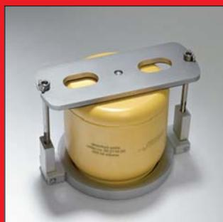
С помощью этой системы дополнительного зажима Вы можете герметично закрыть размольные стаканы для транспортировки между процессом заполнения в Glove-Box и мельницей. С помощью дополнительного адаптера можно также использовать маленькие размольные стаканы.
