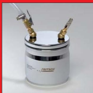
За счет использования специальной крышки на размольном стакане Вы можете измельчать пробы также в среде защитного газа. При этом два клапана обеспечивают простое и надежное заполнение стаканов защитным газом, когда они закреплены в мельнице. Для извлечения и транспортировки без потери газа требуется специальная система дополнительного зажима (смотри ниже).
