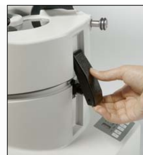
Автоматическое аварийное отключение при открывании
